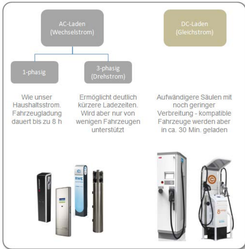
Abbildung 1: Laden mit Wechsel-, Dreh und Gleichstrom
